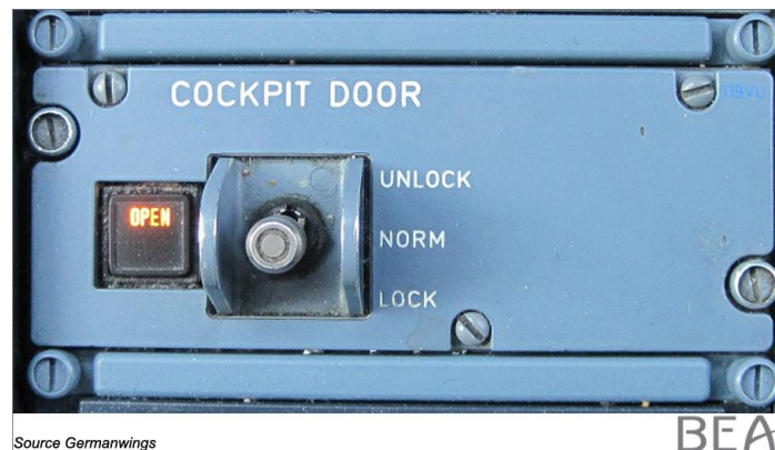
Figura 5. Interruptor de control de la puerta
