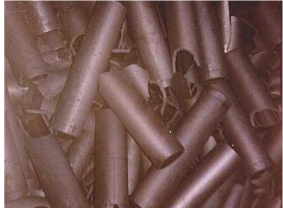
Camisas de grafito. Residuos radiactivos generados durante la operación de la central nuclear Vandellós I, almacenadas en los silos de la central.
