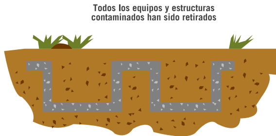
Nivel 3. Instalación desmantelada
