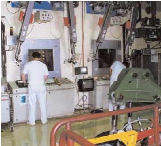
Celda de trituración de las camisas de grafito recuperadas de los silos de almacenamiento de la central nuclear Vandellós I.
