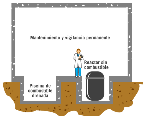
Nivel 1. Instalación en estado casi original
