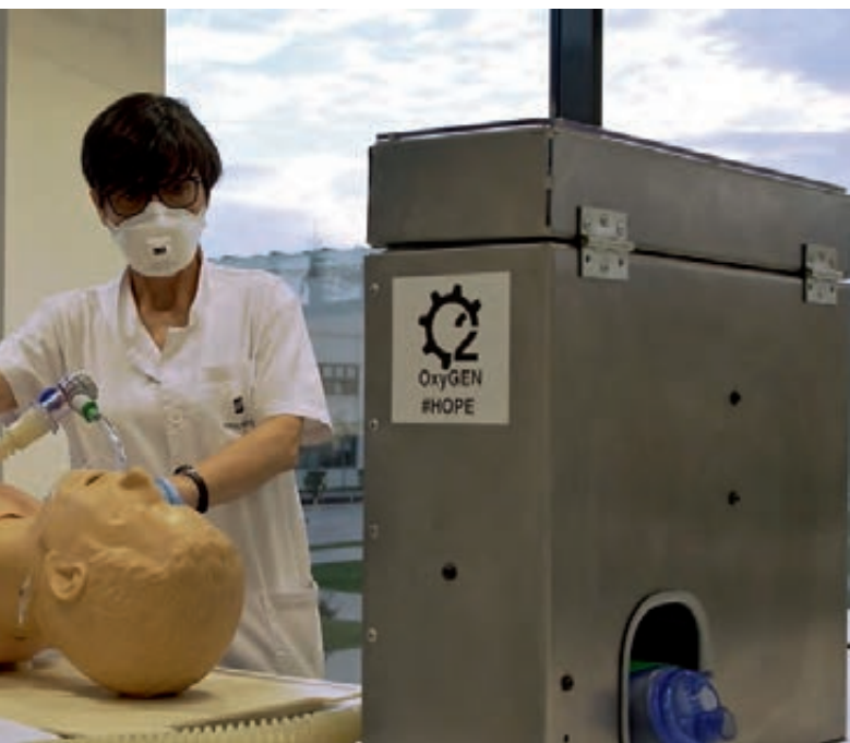
Respirador fabricado por Seat con el motor adaptado de los limpiaparabrisas. SEAT
